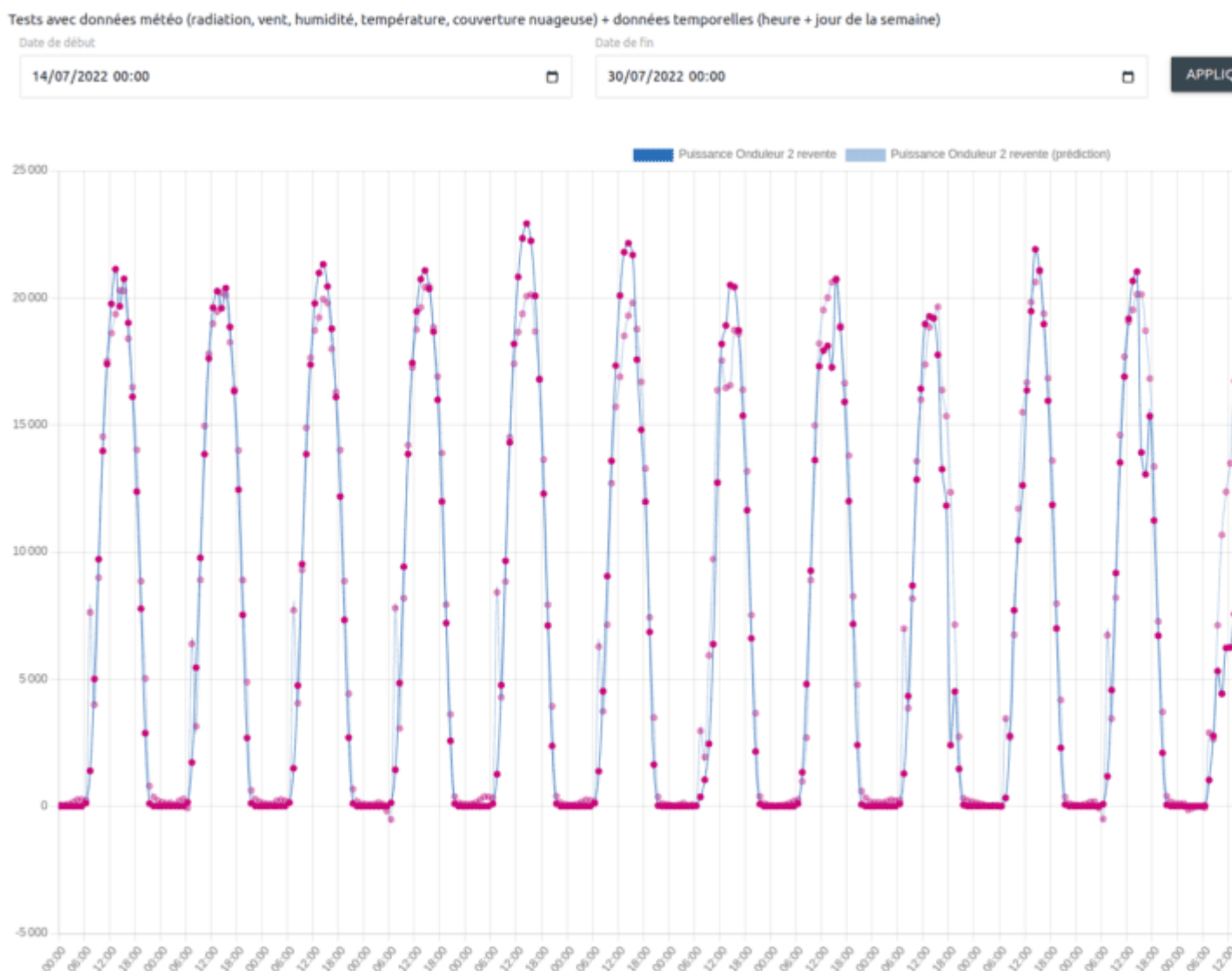
Capture d'écran de la production photovoltaïque réelle et prédite pour une installation
