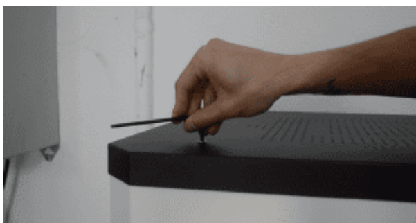
Étape 1 : Dévisser les 4 vis au-dessus de l'armoire à l'aide d'une clé Allen
