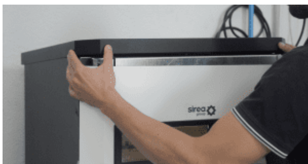
Étape 1 : Dévisser les 4 vis au-dessus de l'armoire à l'aide d'une clé Allen
